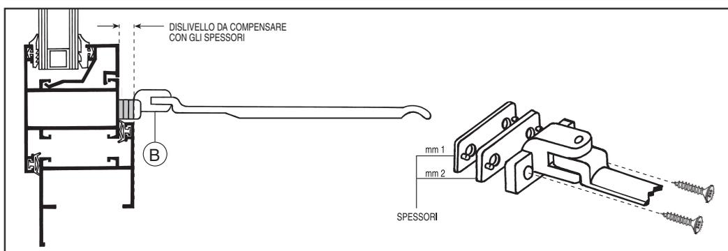
**2** Una volta eseguita la foratura si applica per primo l'elemento **B** sull'anta e si fissa con le viti: Nel caso in cui il serramento presenti un dislivello tra l'anta e il telaio è necessario aggiungere all'elemento **B** degli spessori compensatori fino ad annullare tale dislivello.
