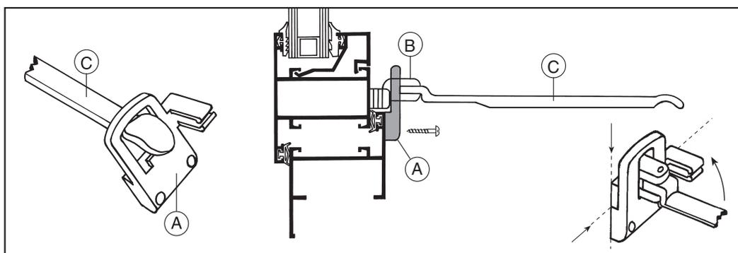
**3** Infilare l'elemento **A** sulla leva **C** leggermente in diagonale per facilitarne l'operazione e fissarlo con le viti sul telaio nei relativi fori già praticati; esso dovrà risultare a filo della battuta del telaio e parallelo all'elemento **B**.
