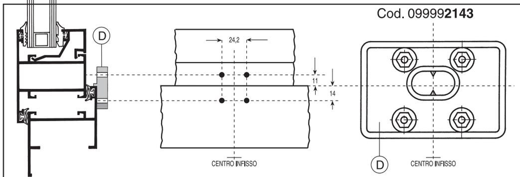
**1** Per facilitare il montaggio del BREZZA, abbiamo realizzato una dima di foratura **D** fornita su richiesta.
