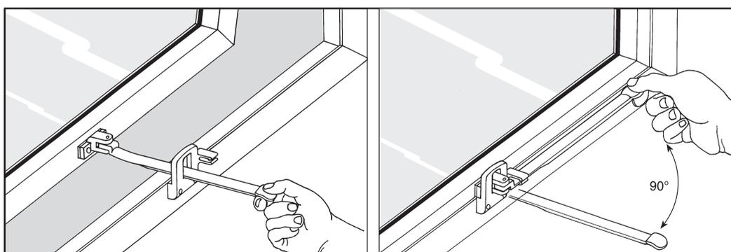
**4** La regolazione di apertura e chiusura dell'anta avviene agendo manualmente sulla leva **C** che dispone di cinque misure: mm 90 - 120 - 150 - 180 - 210; questa si innesta e si blocca nella posizione desiderata per mezzo di un dente presente nell'elemento **A**.
